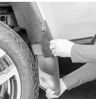
**FR** Sur la bavette garde-boue marquée « LH », assurez-vous que l'attache QuickTurn™ est en position déverrouillée. Positionnez la bavette garde-boue sur l'aile et alignez-la sur les trous correspondants.
