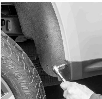
**FR** Repérez les trois (3) vis à tête Torx d'usine indiquées. Utilisez l'embout Torx fourni, la douille appropriée et un rochet pour retirer les vis. Elles ne seront pas réutilisées.
