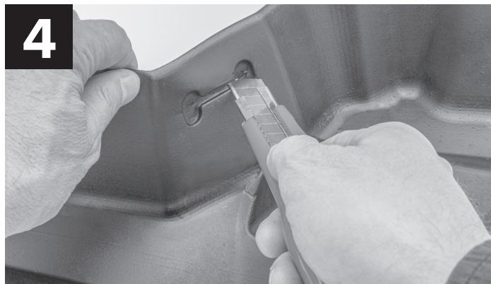
Utilice un cortador de cajas para hacer un corte en la sección con forma de hueso de perro (si corresponde) situada cerca de cada esquina del ImpactLiner. Esto permite que el ImpactLiner encaje sobre los ganchos de carga de la caja de la camioneta.
