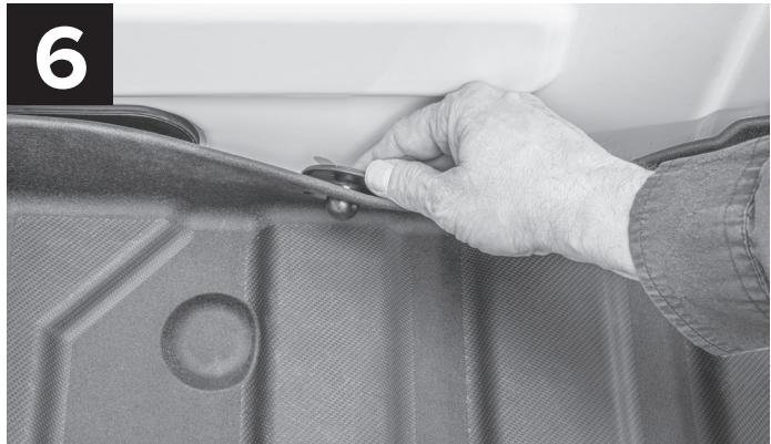
Inserte el dispositivo de bola TechHold a través de cada orificio recortado del ImpactLiner.
