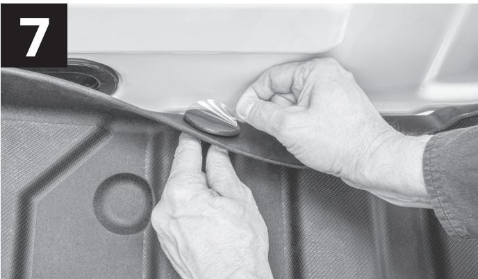
Extraiga la cubierta de plástico de cada bola TechHold y coloque el ImpactLiner hacia abajo mientras presiona la bola TechHold contra la pared de la caja de la camioneta. Mantenga presionado durante un mínimo de 15 segundos para adherir el disco. Asegúrese de que ambos estén adheridos antes de pasar al paso 9.
