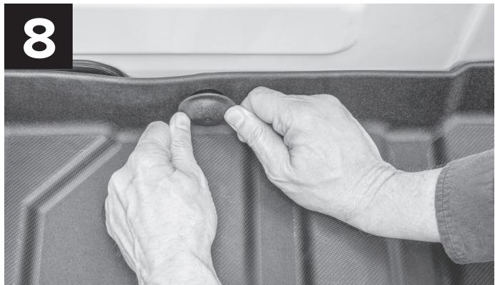
Una vez que los dos dispositivos de bola TechHold estén bien adheridos, coloque el ImpactLiner sobre ellos, de modo que el dispositivo de bola TechHold pase a través de los dos anillos recortados. Sujete el dado TechHold y presione sobre el dispositivo de bola TechHold hasta que se oiga un clic. El ImpactLiner ya está asegurado.
