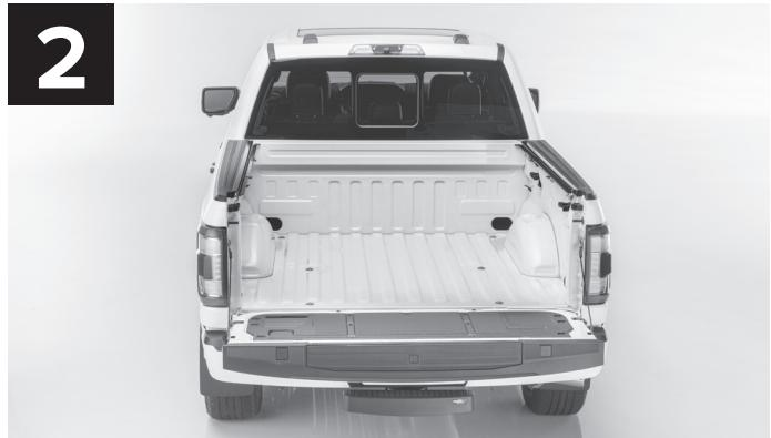
Extraiga el ImpactLiner de la caja de envío y desenrollelo sobre una superficie plana y seca. NO lo instale si la temperatura del ImpactLiner o la de la caja de la camioneta está por debajo de los 50 °F.
