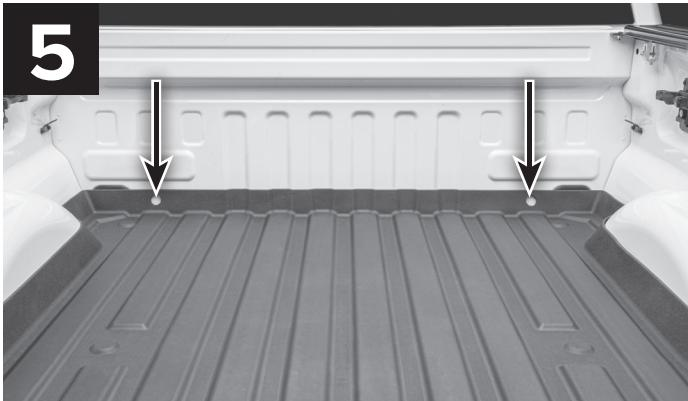
Coloque el ImpactLiner en la caja de la camioneta y localice dos orificios previamente recortados en la parte delantera del ImpactLiner. Utilice un paño para limpiar, con agua y jabón suave, el área situada detrás de los orificios recortados. Déjela secar. Utilice el paño con alcohol provisto para preparar la superficie de la pared de la caja de la camioneta para los dispositivos de retención de bola y dado TechHold.
