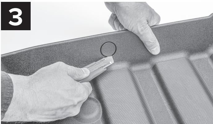
Localice los dos anillos recortados en o cerca de la pared delantera del ImpactLiner. Utilice un cortador de cajas para recortar las secciones que tienen la marca. Asegúrese de que los dispositivos de retención de bola y dado TechHold encajen dentro de los anillos recortados.
