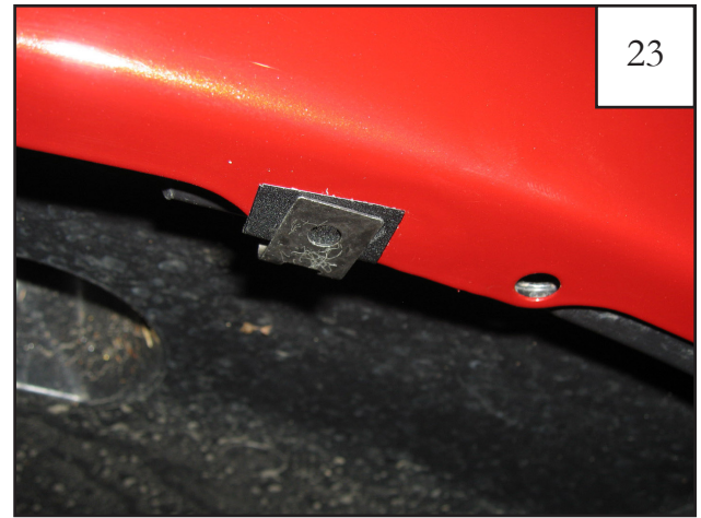
Install clip (SW1-0022) over 1"x1.5" Black Tab.
