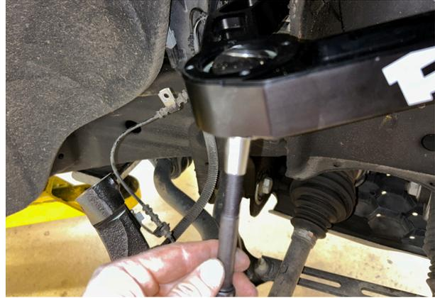
Fig. 17: Insert bolt.
