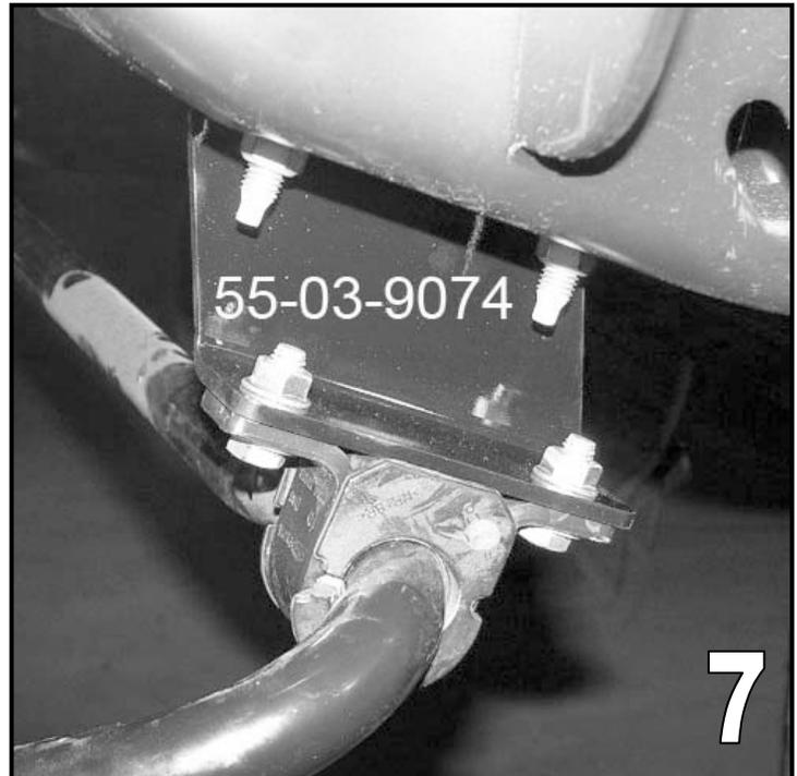
**13) ANTI-SWAY BAR DROP BRACKETS...[DIAGRAM 7]**
