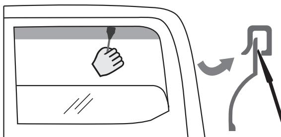
9. Pour assurer une meilleure installation du déflecteur et une meilleure adhérence entre le ruban et la surface du joint en caoutchouc, il est vivement recommandé d'utiliser la lame en plastique en la déplaçant lentement entre le joint en caoutchouc intérieur de la fenêtre et le déflecteur ;
