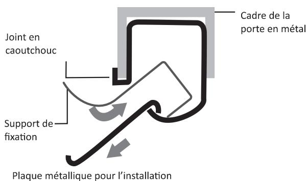
3. Placez le support de fixation dans le canal et remettez le joint en caoutchouc dans sa position initiale.
