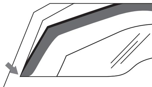
Опустите переднюю часть дефлектора на металлическую скобу – упор, как показано на рисунке.
