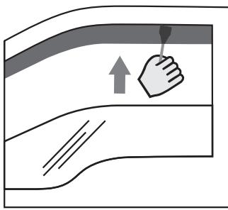
Per una migliore installazione del deflettore e un'adesione ottimale tra il nastro e la superficie della guarnizione in gomma, si consiglia di utilizzare la spatola di plastica, muovendola lentamente tra la guarnizione in gomma interna del finestrino e il deflettore.
