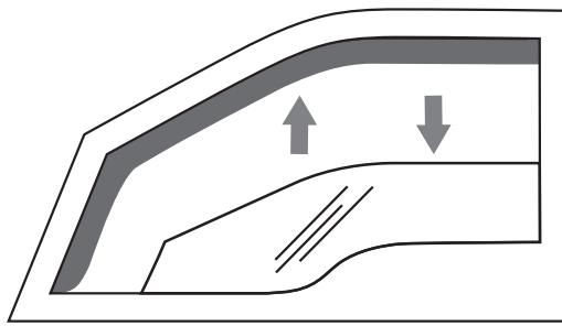
Heben Sie die Scheibe an, bis sie den Deflektor berührt. Ziehen Sie den Deflektor vorsichtig nach außen und ziehen Sie die Scheibe mit abrupten Bewegungen auf. Wiederholen Sie diesen Vorgang 4-5 Mal und lassen Sie dann die Scheibe geschlossen.
