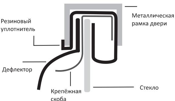
Установите крепёжную скобу в канал и верните уплотнительную резинку в обычное состояние.
