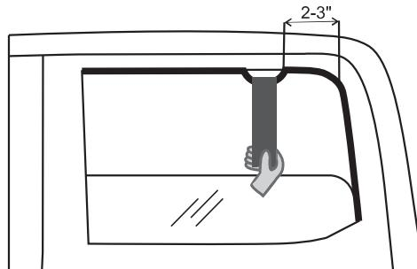
2. Pour positionner le luminaire, courbez le bord du joint en caoutchouc du cadre arrière de la fenêtre de 2 à 3 pouces en utilisant une plaque métallique spéciale, comme indiqué sur la photo.
