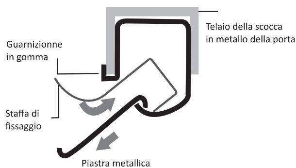
Posizionare la staffa di fissaggio nella canalina e riportare la guarnizione in gomma alla sua posizione originale.
