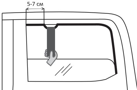
Отогните край уплотнительной резинки на 2-3" от передней рамки окна. Установите крепёжную скобу в канал и верните уплотнительную резинку в обычное состояние.
