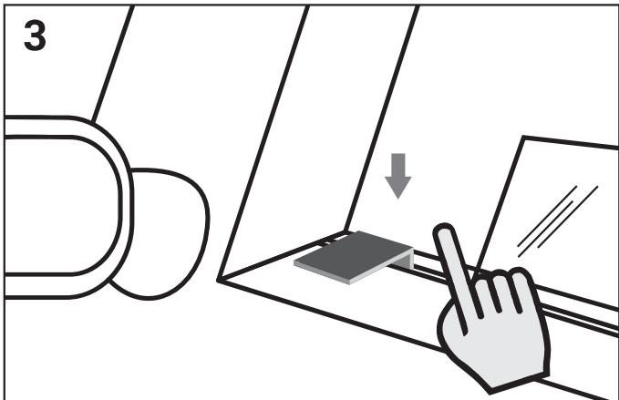
Posizionare la staffa metallica sulla guarnizione in gomma inferiore, il più vicino possibile al telaio del finestrino anteriore.
