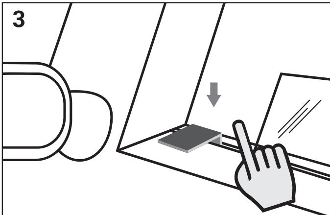
Platzieren Sie den Metallbügel auf der unteren Gummidichtung so nah wie möglich am Rahmen der Frontscheibe.
