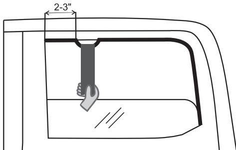
5. Pliez le bord du joint en caoutchouc à partir du cadre avant de la fenêtre de 2 à 3 pouces. Placez le support de fixation dans le canal et remettez le joint en caoutchouc dans sa position initiale.
