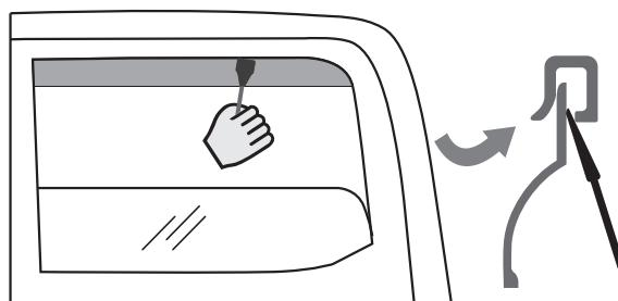
Для более качественной установки дефлектора и увеличения адгезии скотча и поверхности уплотнительной резинки, используйте пластиковую лопатку, проводя ей между внутренней уплотнительной резинкой окна и дефлектором.
