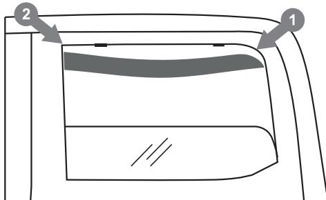
Der Deflektor muss von hinten beginnend eingebaut werden. Legen Sie dazu den hinteren Teil des Deflektorrahmens in den Kanal und schieben Sie den vorderen Teil nach oben. Positionieren Sie den gesamten Deflektorrahmen in den Scheibenkanal und platzieren Sie den Rahmen zwischen den Befestigungsbügeln und der Gummidichtung, wie in der Abbildung gezeigt.
