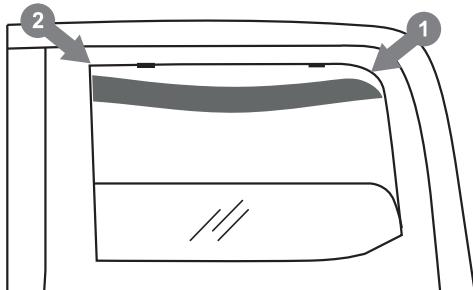
7. Le déflecteur doit être installé en commençant par l'arrière. Pour ce faire, placez la partie arrière du cadre de déflecteur dans le canal et déplacez la partie avant vers le haut. Positionner le cadre entier du déflecteur dans le canal de la fenêtre, en plaçant le cadre entre les supports de fixation et le joint en caoutchouc, comme indiqué sur l'illustration.
