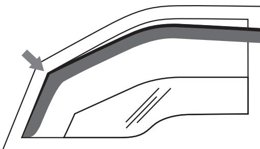
6. Desplace el deflecto hacia delante, encajando completamente el marco en el riel. Asegúrese de que el deflecto está colocado sobre el marco inferior de la ventanilla.
