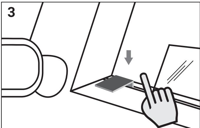
3. Placez le support en métal sur le joint en caoutchouc inférieur aussi près que possible du cadre de la fenêtre avant.
