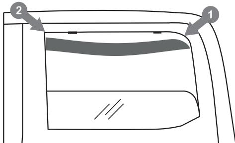
Il deflettore deve essere installato partendo dalla parte posteriore. Posizionare la parte posteriore del telaio del deflettore nella canalina e spostare la parte anteriore verso l'alto. Posizionare tutto il telaio del deflettore all'interno della canalina del finestrino, interponendo il telaio tra le staffe di fissaggio e la guarnizione in gomma, come mostrato nell'immagine.
