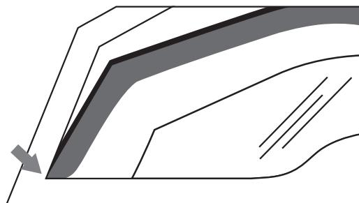
5. Baje la parte frontal del deflecto en el soporte metálico, tal y como se muestra en la imagen.
