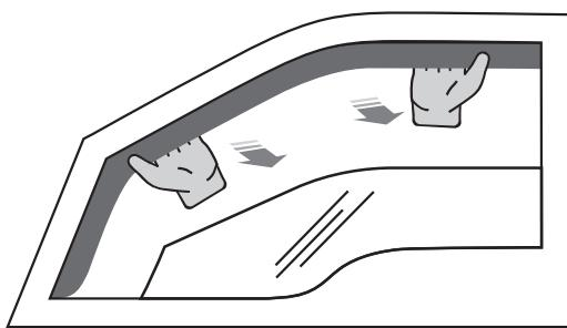
После того как дефлектор установлен, поправьте его положение, осторожно потянув дефлектор наружу.
