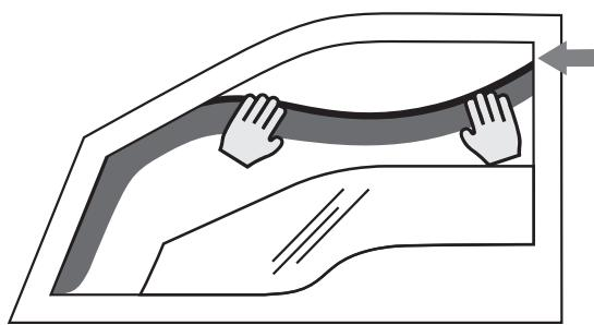
Beugen Sie den mittleren Teil des Deflektors nach außen, führen Sie den hinteren Teil des Deflektors in den Kanal ein und halten Sie darüber einen Spalt frei.
