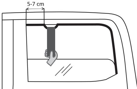
Biegen Sie den Rand der Gummidichtung vom Vorderrahmen der Scheibe um 5-7 Zentimeter. Platzieren Sie den Befestigungsbügel in den Kanal und bringen Sie die Gummidichtung wieder in ihre ursprüngliche Position zurück.
