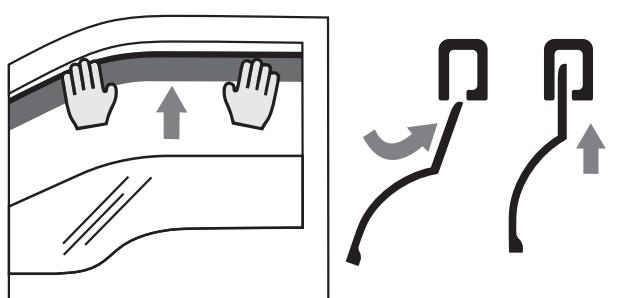
8. En commençant par la partie avant du déflecteur, insérez-le dans le canal de la fenêtre.
