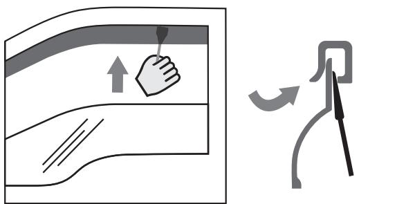
10. Pour assurer une meilleure installation du déflecteur et une meilleure adhérence entre le ruban et la surface du joint en caoutchouc, il est vivement recommandé d'utiliser la lame en plastique en la déplaçant lentement entre le joint en caoutchouc intérieur de la fenêtre et le déflecteur.
