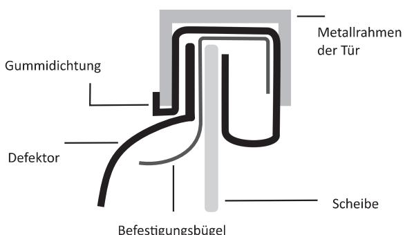
Platzieren Sie den Befestigungsbügel in den Kanal und bringen Sie die Gummidichtung wieder in ihre ursprüngliche Position zurück.
