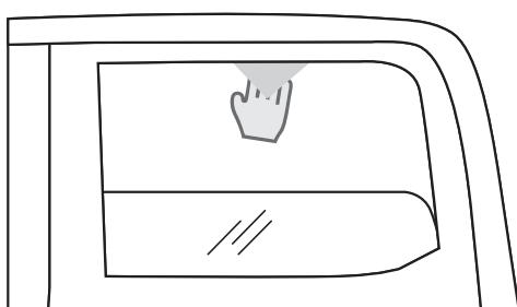
Assicurarsi che i finestrini dell'auto siano puliti e asciutti. Quindi, abbassare completamente i finestrini laterali e rimuovere il grasso dalla superficie interna della canalina del finestrino, utilizzando una salvietta imbevuta di alcol.
