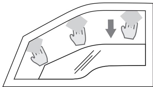
1. Assurez-vous que les vitres de la voiture sont propres et sèches. Ensuite, abaissez complètement les vitres latérales et nettoyez la graisse de la surface intérieure du canal de la fenêtre avec une lingette imbibée d'alcool.
