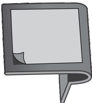
Posizionare una piccola quantità di nastro protettivo trasparente, incluso nel kit, sulla superficie piana della staffa metallica, come mostrato nell'immagine.
