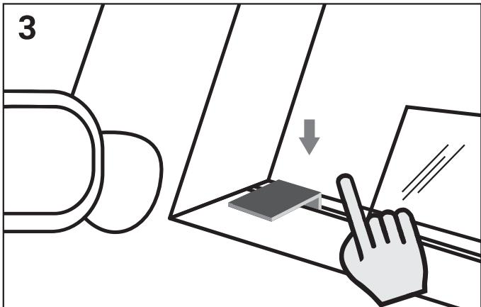
Установите металлическую скобу – упор на нижнюю уплотнительную резинку как можно ближе к передней рамке окна.
