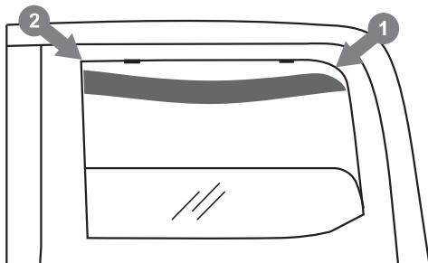
Начинать установку дефлектора необходимо с задней части, для этого уприте заднюю часть рамки дефлектора в канал и поднимайте переднюю часть дефлектора вверх. Полностью вставьте всю рамку дефлектора в канал окна, таким образом, чтобы рамка дефлектора оказалась между креплениями и уплотнительной резинкой. Как показано на рисунке.
