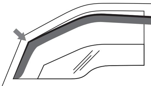
Schieben Sie den Deflektor nach vorne, so dass der Deflektormrahmen vollständig in den Kanal passt. Vergewissern Sie sich, dass der Deflektor über dem unteren Scheibenrahmen angebracht ist.
