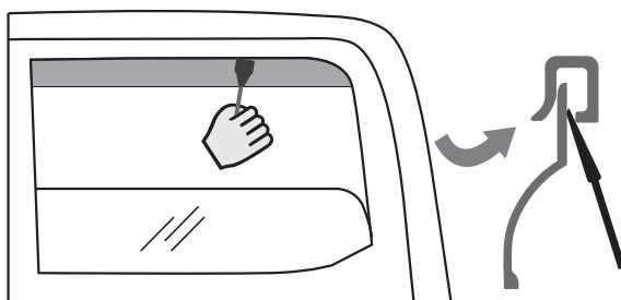
Um eine bessere Montage des Deflektors und eine bessere Haftung zwischen dem Band und der Oberfläche der Gummidichtung zu gewährleisten, wird dringend empfohlen, die Kunststoffklinge zu verwenden und sie langsam zwischen der inneren Gummidichtung der Scheibe und dem Deflektor zu bewegen.
