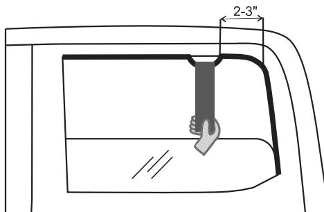
2. Para colocar el accesorio, doble el filo de goma desde el marco posterior de la ventana 2-3 pulgadas, utilizando una lámina metálica especial, tal y como se muestra en la imagen.
