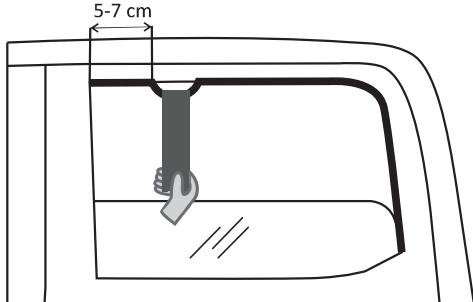
Piegare il bordo della guarnizione in gomma dal telaio anteriore del finestrino di 5-7 cm. Posizionare la staffa di fissaggio nella canalina e riportare la guarnizione in gomma alla sua posizione originale.
