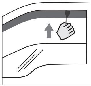
Um eine bessere Montage des Deflektors und eine bessere Haftung zwischen dem Band und der Oberfläche der Gummidichtung zu gewährleisten, wird dringend empfohlen, die Kunststoffklinge zu verwenden und sie langsam zwischen der inneren Gummidichtung der Scheibe und dem Deflektor zu bewegen.
