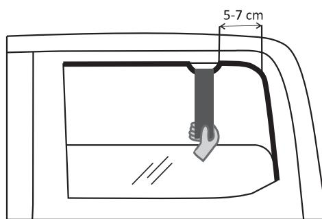
Um die Befestigung zu positionieren, biegen Sie die Kante der Gummidichtung vom hinteren Rahmen der Scheibe mit Hilfe einer speziellen Metallplatte um 5-7 Zentimeter ab, wie in der Abbildung gezeigt.
