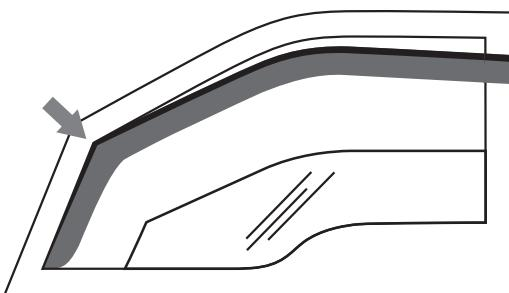
Spostare il deflettore in avanti, inserendo completamente il telaio del deflettore all'interno della canalina. Assicurarsi che il deflettore sia posizionato sopra il telaio inferiore del finestrino.
