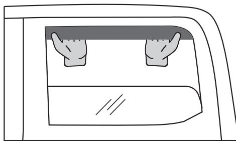
8. Inmediatamente después de instalar el deflector, ajuste la posición tirando hacia fuera con cuidado.
