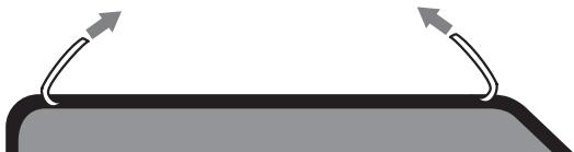
Entfernen Sie die Schutzfolie von dem Klebeband am Defektor.
