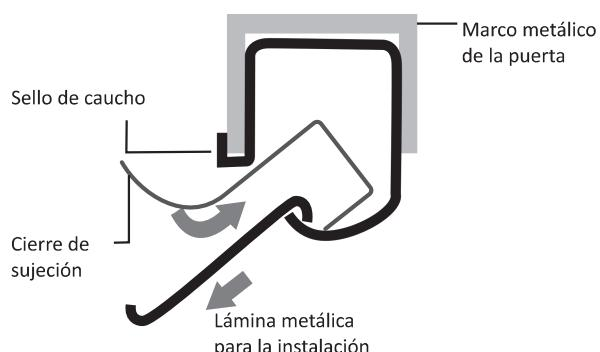
3. Coloque el soporte de sujeción en el riel y vuelva a colocar el filo de goma en su posición original.
